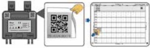
Abb. A: Abreißen und Einkleben des QR-Code-Etiketts
