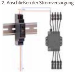
Abb. I: Befestigung der Stromversorgung an der Schiene
